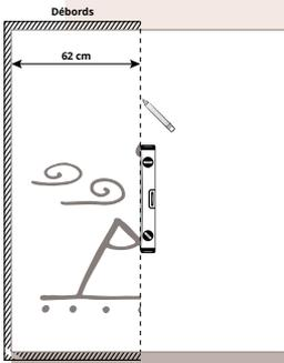
Il est essentiel que la première lé soit droite. Pour cela, vous pouvez tracer des marques verticales correspondantes à la largeur d'une lé (62 cm) à partir de l'angle du mur avec un niveau à bulle, un mètre et un crayon. Utilisez les marques pour positionner votre première lé. Les lignes ne doivent pas être trop marquées afin de ne pas être visibles sous le vinyle. L'excédant de vinyle adhésif devra être retiré à la fin de la pose.
